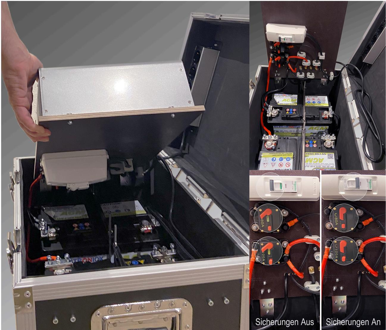
Stecken sie den VAC Stecker (230V) in eine Steckdose mit Land-/Netzstrom Anschluss und die Verbraucher (Tiefkühler, Kühlschrank, Heizungspumpe etc.) in die VAC 230V Steckdose am Power-Backup.
